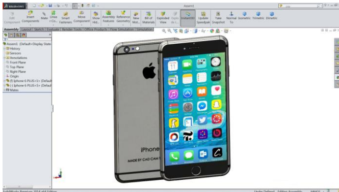
maquette numérique réalisée avec un logiciel de CAO : Solidworks
